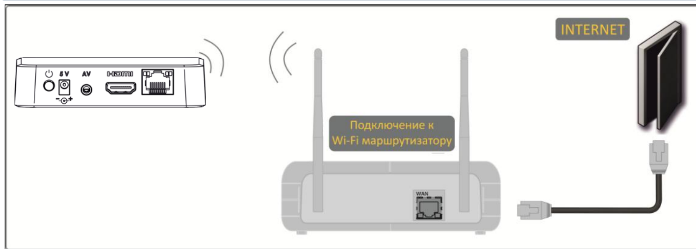
Рисунок 11 – Подключение к сети провайдера, используя Wi-Fi маршрутизатор
